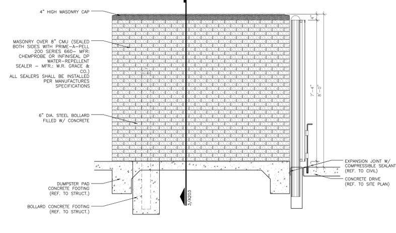
**4 DUMPSTER ENCLOSURE SIDE ELEVATION**
